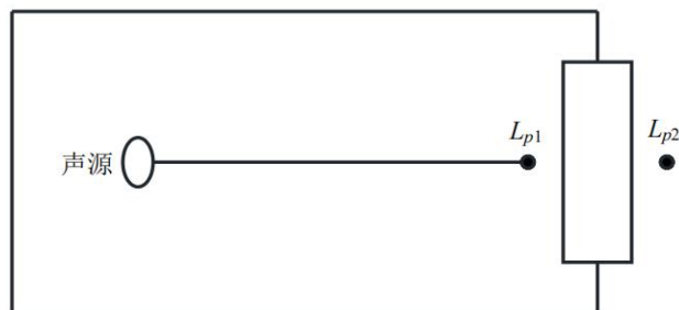
图 4-4 室内声源等效为室外声源图例
