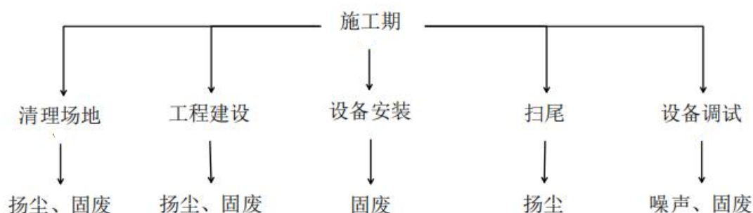
图 5-1 项目施工期建设流程及产污节点图
