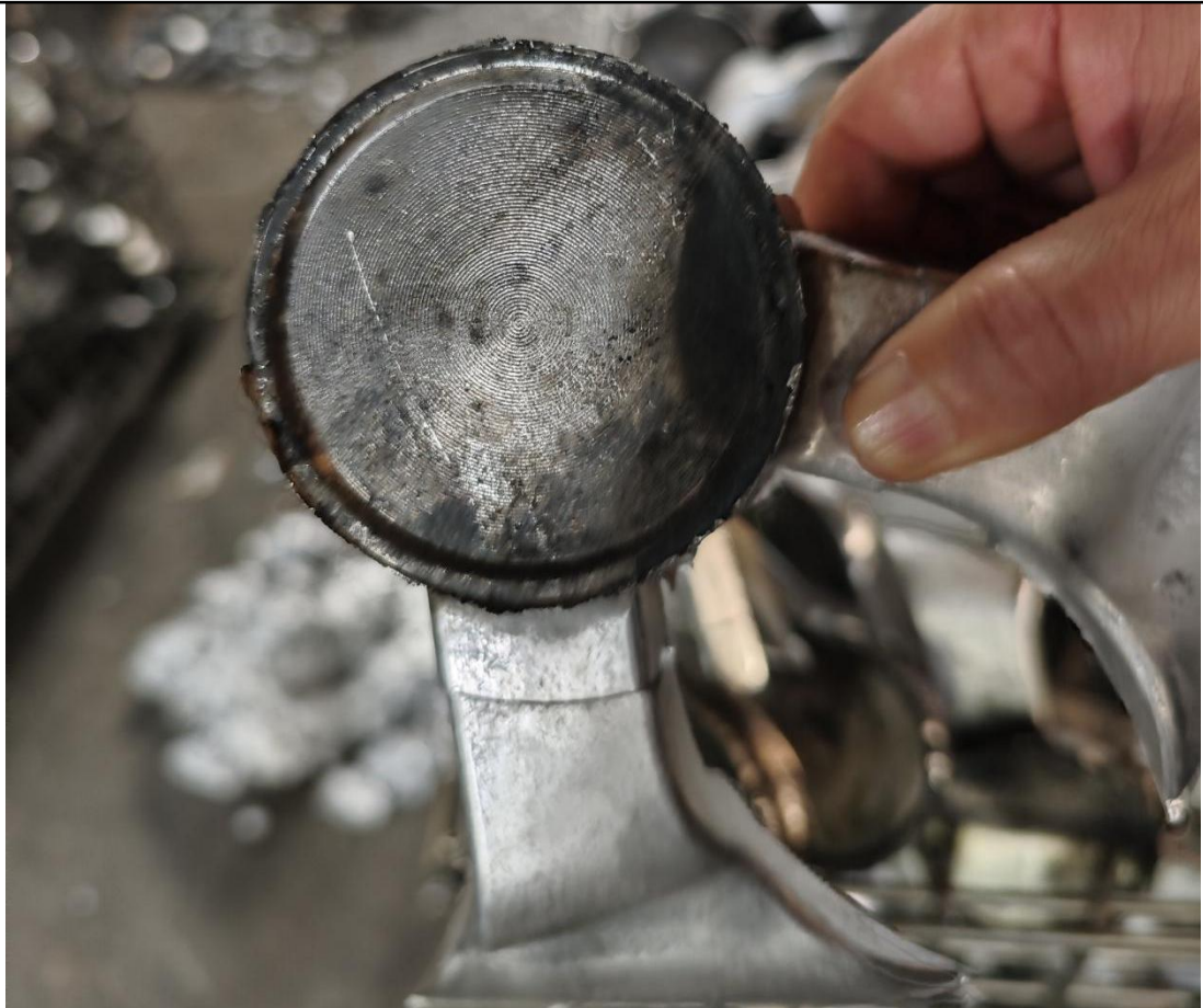
图 4-1 冲头润滑颗粒（熔融态）在压铸件上产生的接触印迹（被冲边）
